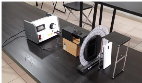
Fig. 3.3.2 – Dispozitivul experimental pentru verificarea legii lui Malus
